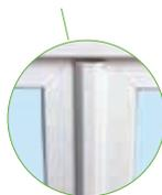
Les ouvrants Kiétude ont été conçus avec une sixième chambre d'isolation sur l'extérieur portant l'épaisseur du profil à 78 mm. En désaffleurer et de forme galbée, cette chambre supplémentaire améliore les performances thermiques et augmente la résistance mécanique de l'ouvrant. De plus, le débord de l'ouvrant forme un rejet d'eau facilitant l'évacuation des eaux de ruissellement.
